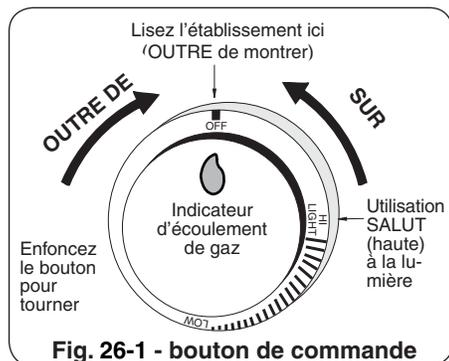
**Remarque:** s'il est équipé, **NE PAS** allumer plus d'une soupape à la fois pour l'éclairage électronique ou manuel.
